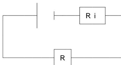
Damit ergibt sich als die tatsächliche Spannung der Batterie nicht der Idealwert  $U$ , sondern  $U' = U - U_i$ , wobei  $U_i$  den inneren Spannungsabfall angibt.  $U_i$  lässt sich über das OHMsche Gesetz auch berechnen:  $U_i = R_i I$  – der Spannungsabfall ist also proportional zur Stromstärke.
